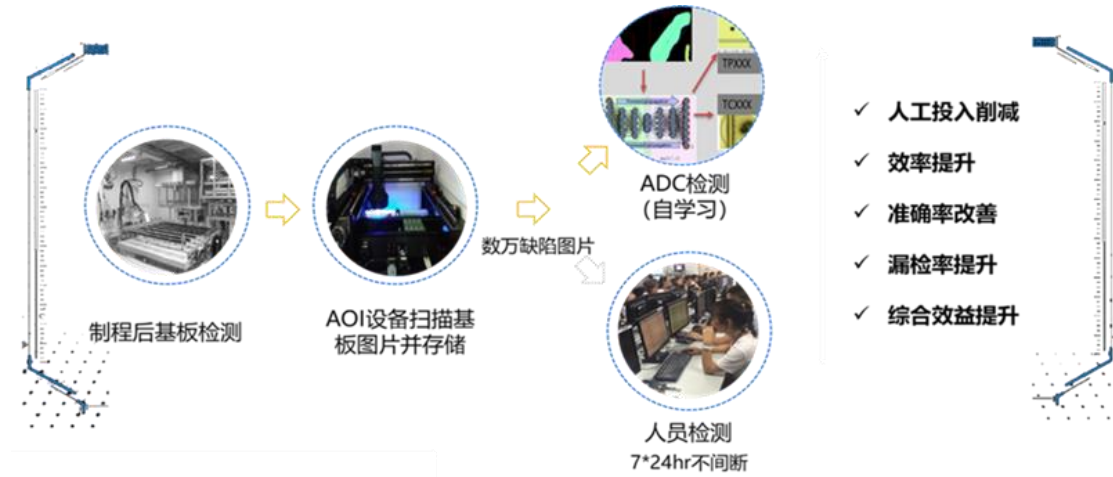
图 3: 自动缺陷分类 VS 人工分类
