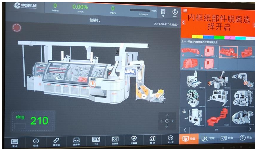
图 7 基于 CPS 的远程控制与故障检测
