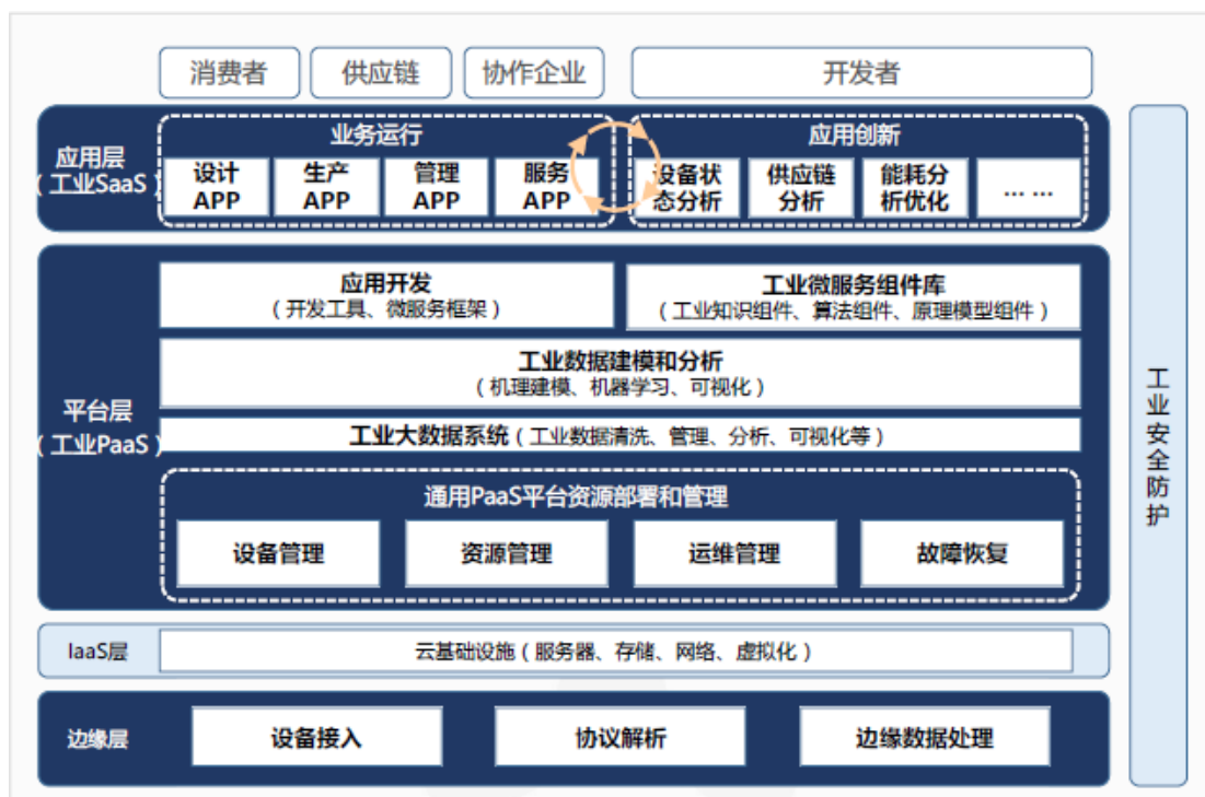
图 31 工业互联网平台功能架构图 [12]
