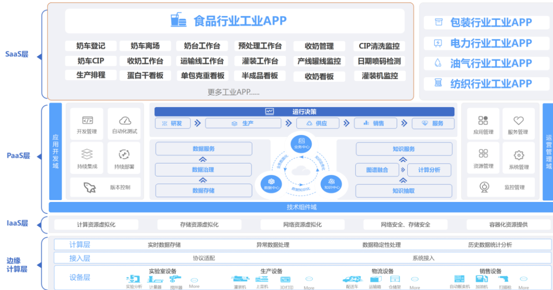
图 5 工业互联网平台 I.Smart 架构示意图
