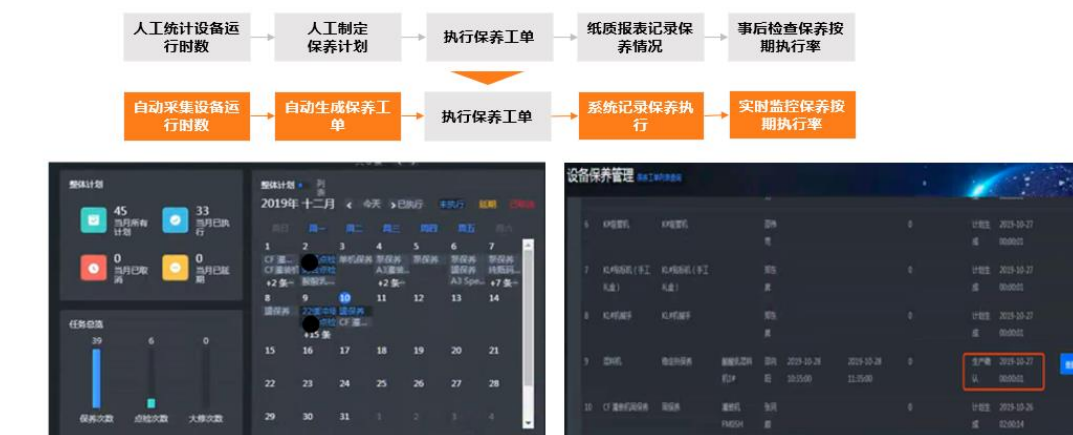
图 20 设备管理维护过程示意图
