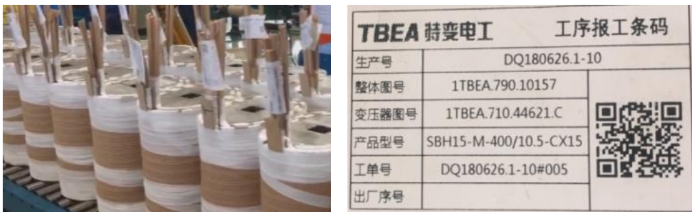
图 变压器线圈、报工二维码标识
