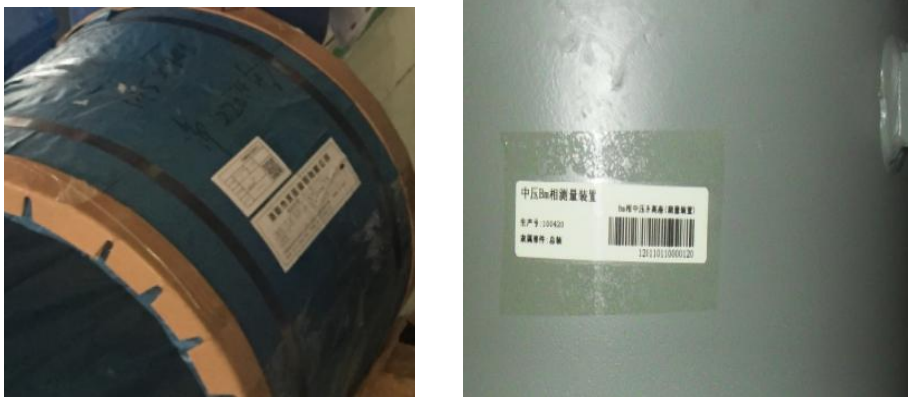
图 变压器线材二维码、测量装置条码标识
