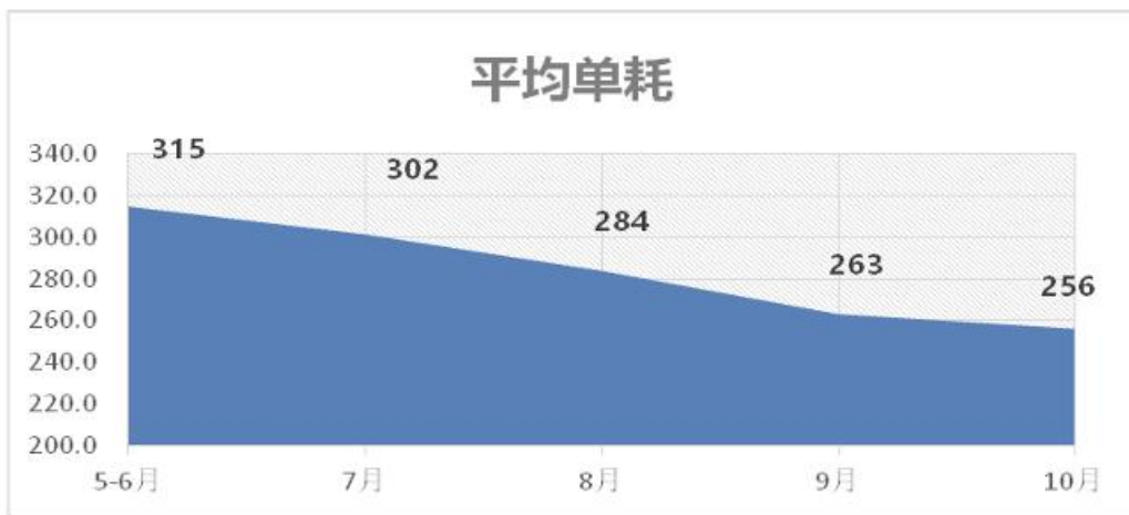
图 94 生产设备经系统分析及推荐参数调优后降低
